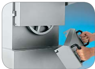
1. Cassetto raccolta scarti facilmente estraibile per la pulizia Removable wastage tray for easy cleaning.
